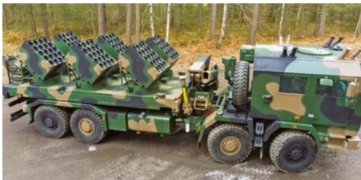
10. ÁBRA. Lengyel Baobab-K műszaki aknaszóró rendszer [20]
