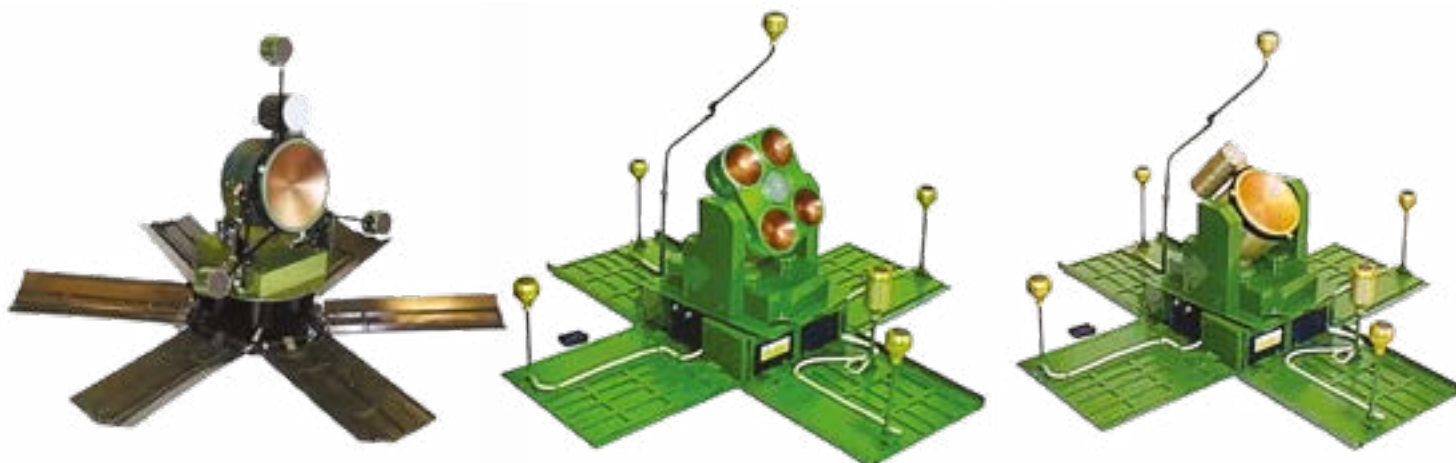
12. ÁBRA. Bumerang orosz helikopter elleni akna [11; 156.]
