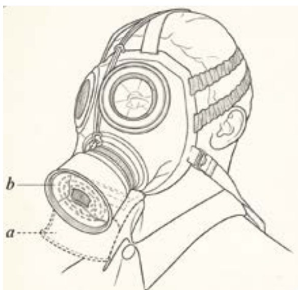
4. ÁBRA. 18M gázálarc illusztrációja. A: készletléti (tárolási) állapotban (a gázálarc és a szűrőbetét egy zsinórral összekötve), B: védelmi helyzetben (a szűrőbetét a gázálarcra összeszerelve) [10]
