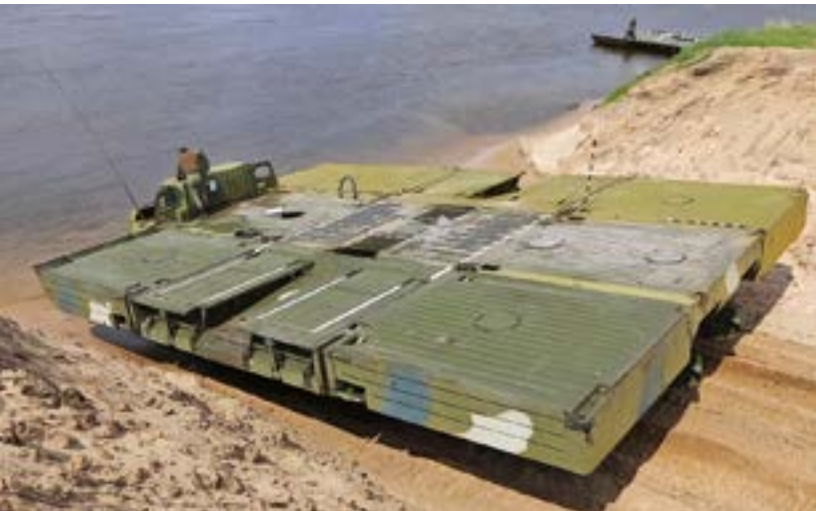
8. ÁBRA. PMM 2M önjáró komp [31]
