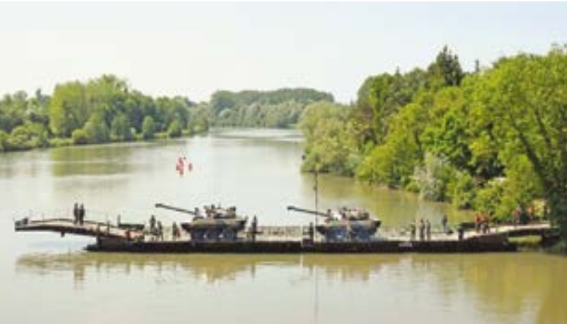
17. ÁBRA. Taktikai rámppal szerelt PFM komp [49]
