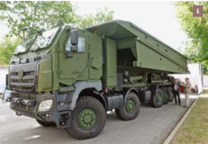
6. ÁBRA. Leguan RMMV HX 10×10 hídvető gépjármű [29]
