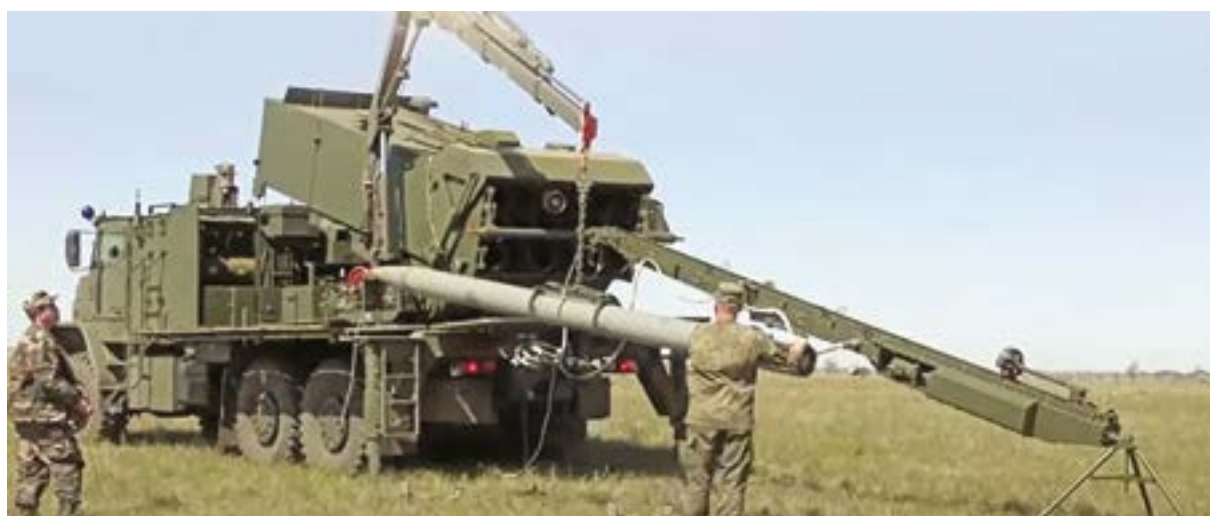
5. ÁBRA. TOSz-2 nehéz lángrésző töltése saját beépített hidraulikus daruja segítségével [8]
