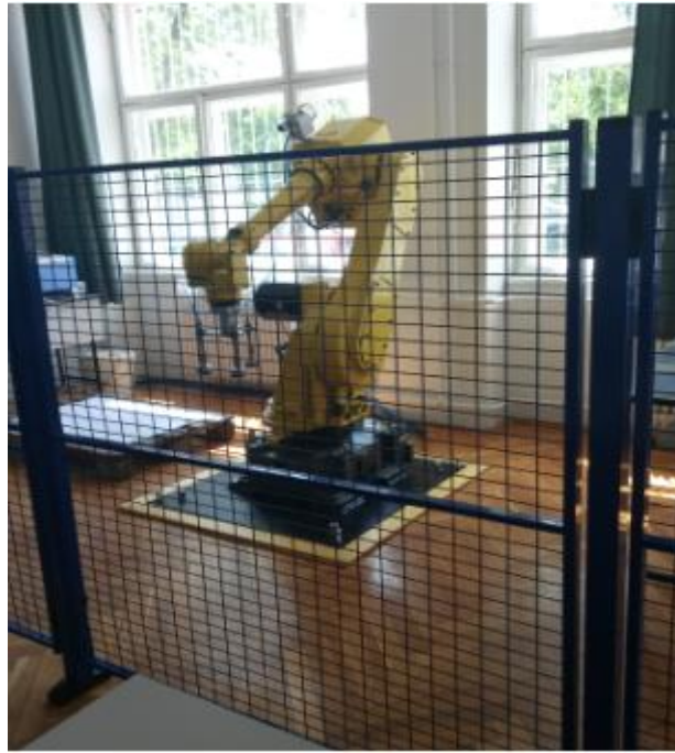
2. ábra: A Műszaki Intézet 2. laborjában telepített és beüzemelt FANUC ipari robot (saját fénykép)
