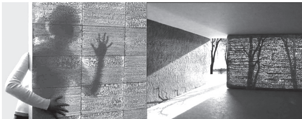
4. kép: A fényáteresztő beton különleges optikai hatása.
