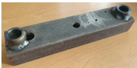
8. ábra. Hegesztett U-profil
