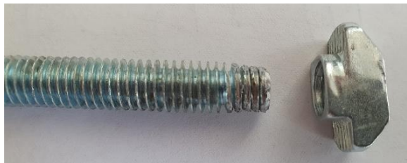
11. ábra. A sérült menetes szár
