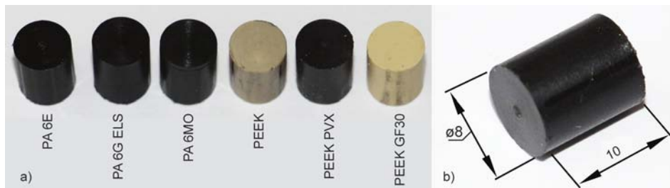
3. ábra. A vizsgált polimerek és kompozitjaik külső megjelenése és a próbatestek méretei
