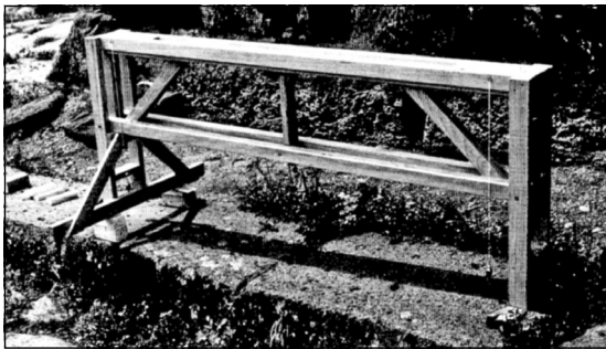
Abbildung 22: Chorobates Rekonstruktion von J-P. Adam. (ADAM 1989.18.)
