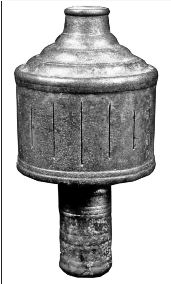
Abbildung 25: Bei L'Orme, Ennemain gefundene römische Winkeltrommel
