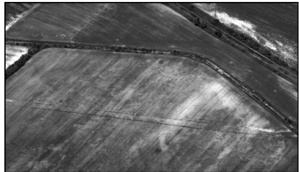
Abb. 6. Merkmale der unterirdischen Fernleitung mit doppeltem System
