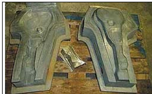
2. ábra: Mélyhúzószerszám Kayem-ötvözetből
