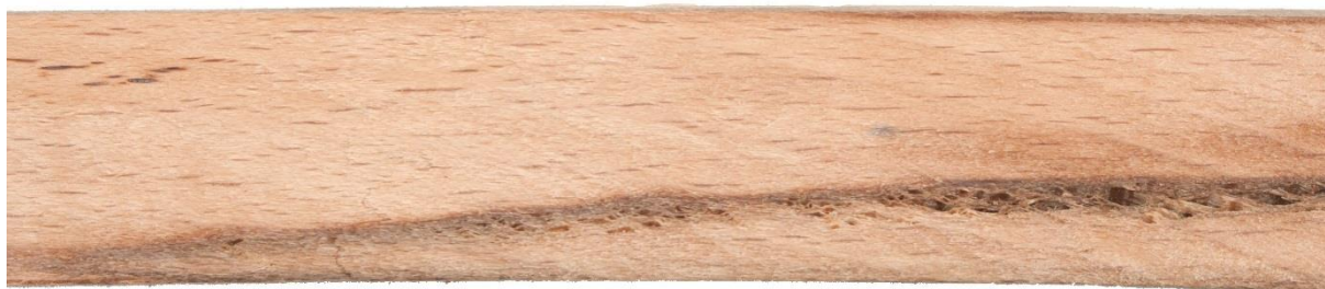
3. ábra. Repedések az álgeszt erősen elszíneződött részében
