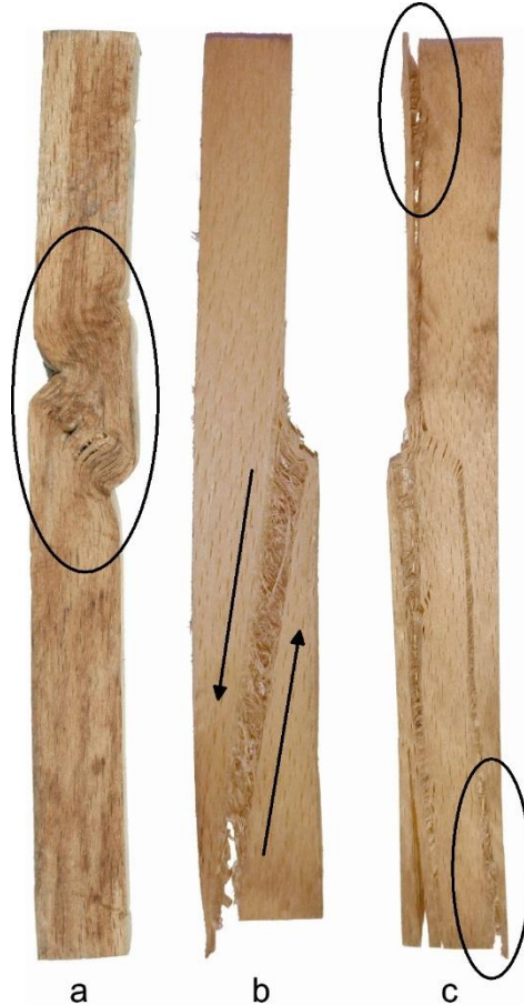
4. ábra. Példák a tömörítési hibákra (a: alacsony tömörítési sebesség miatti elakadás okozta megrogyás; b: rostkifutás miatti repedés; c: nyomólapok alóli kilógás okozta hasadás) [3]
