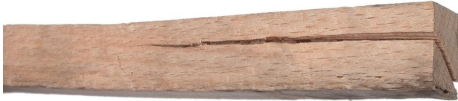
5. ábra. Száradási bütürepedésből a tömörítés következtében létrejött hosszanti hasadás
