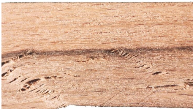
2. ábra. Megrogyások az álgesztben, míg a fölötte látható álgesztmentes rész sértetlen
